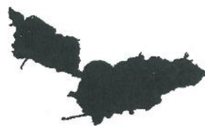
Abbildung 9: Partikel des frisch applizierten Materials (A1) mit niedriger Sphärizität
