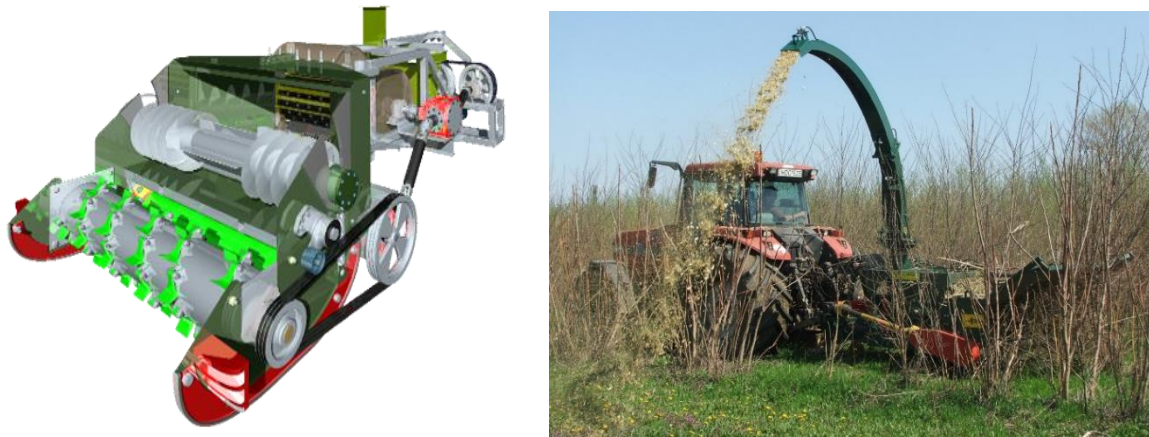
5. ábra: Sorfüggetlen betakarítógép: a) elvi kialakítás; b) az elkészült gép munkában (forrás: Horváth - Kaczor, 2013; Horváth B. 2016)
