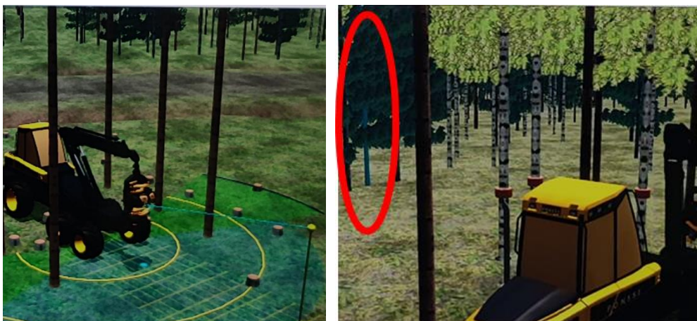
14. ábra. 3D-s pontfelkereséses állományban és három fa irányított döntése (Ponsse Ergo)
