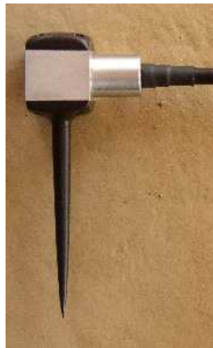
8. ábra: A használt gyorsulásérzékelő közelről (Divós 2004)
