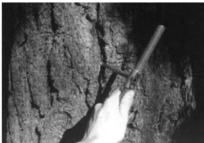
6. ábra: Pressler fúró alkalmazása a gyakorlatban (SZALAI 2001)
