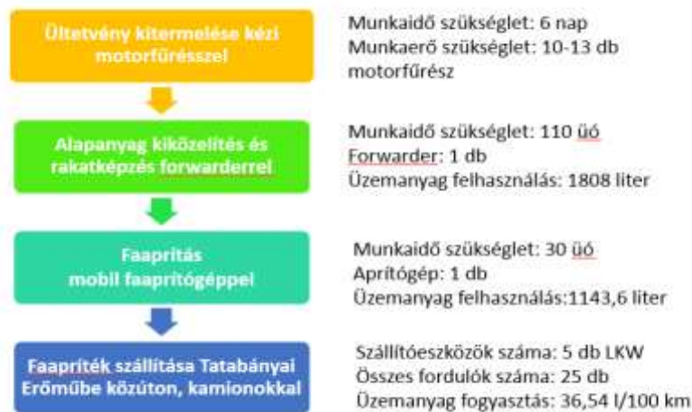
5. ábra: Az ültetvény faanyag letermelésének munkaműveletei, gépei, üzemanyag fogyasztás
