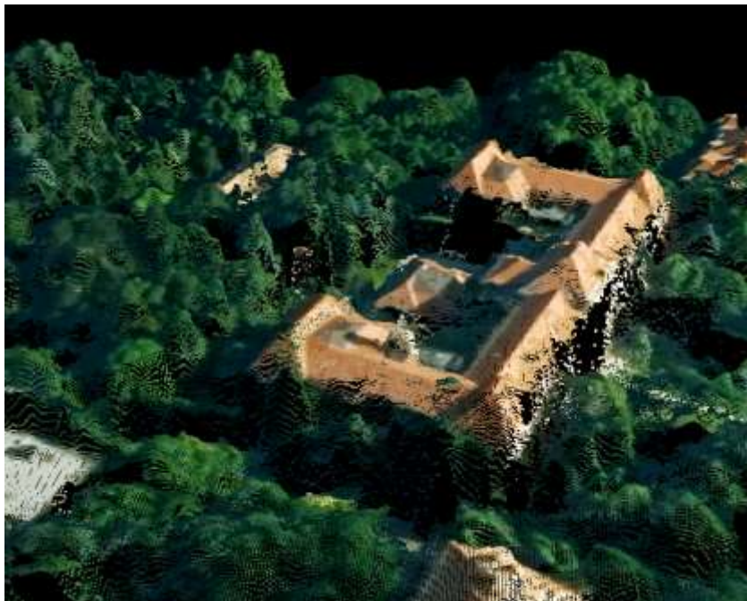
3. ábra: Nyers színezett pontfelhő részletének 3-dimenziós megjelenítése az egyetem B-épületéről.
