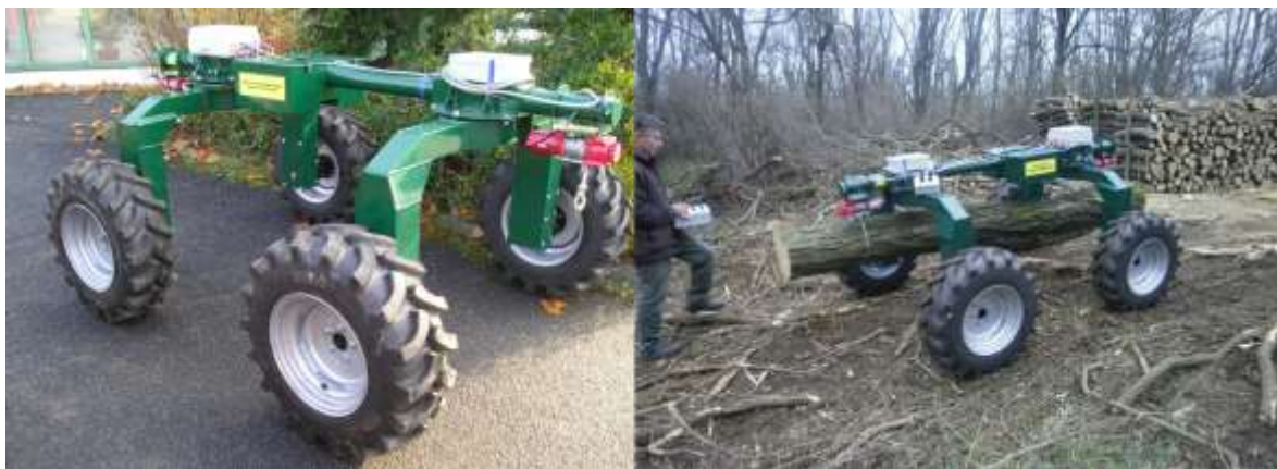
4. ábra: Az erdészeti elektromos közelítőgép munka közben
