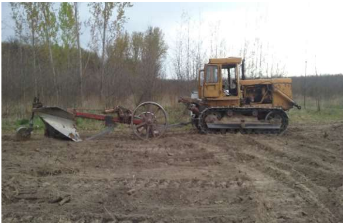
2. ábra: Láncotlappal erőgéppel végzett mélyszántás (Forrás: Saját kép)
