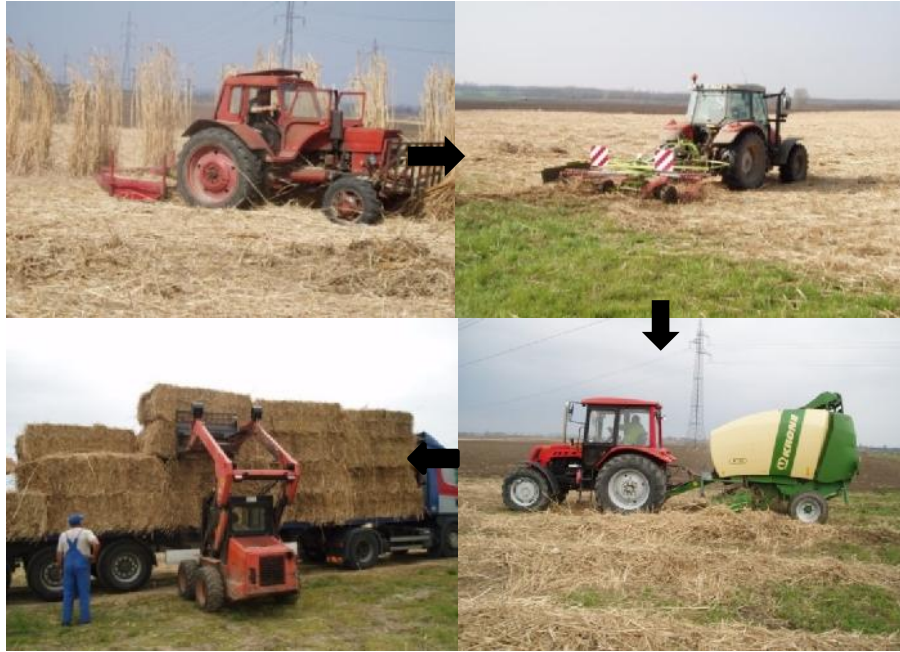
1. ábra: A Miscanthus sinensis Tatai betakarítási technológiájának művelei (PINTÉR 2015)
