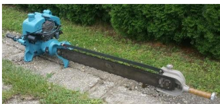
3. kép: KL-150 kétszemélyes láncfűrész (fotó: Tóth J.)
