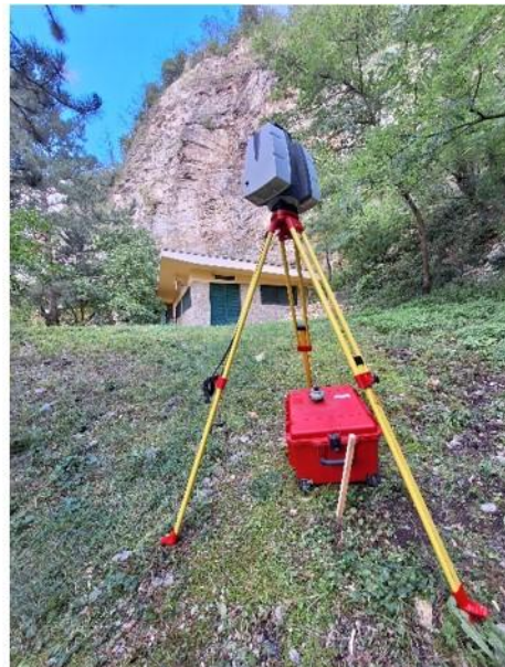
2. ábra: A méréshez használt műszerek: Stonex X120GO SLAM és Leica P40
