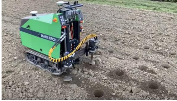
17. kép: Kétsoros gödörfúró robot (Hári Kft. gyártmánya) (fotó: Major T.)
