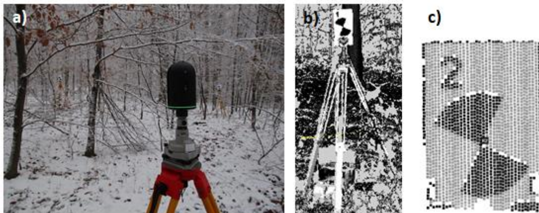
1. ábra. Téli felmérés Leica BLK360 lézerszkennelvel (a). Az állványra helyezett kapcsolójel intenzitás szerinti leképeződése a ponthalmazban (b), egy kapcsolójel közelről, amelyen látszik, hogy az intenzitásértékek a pontokhoz tartoznak (c)
