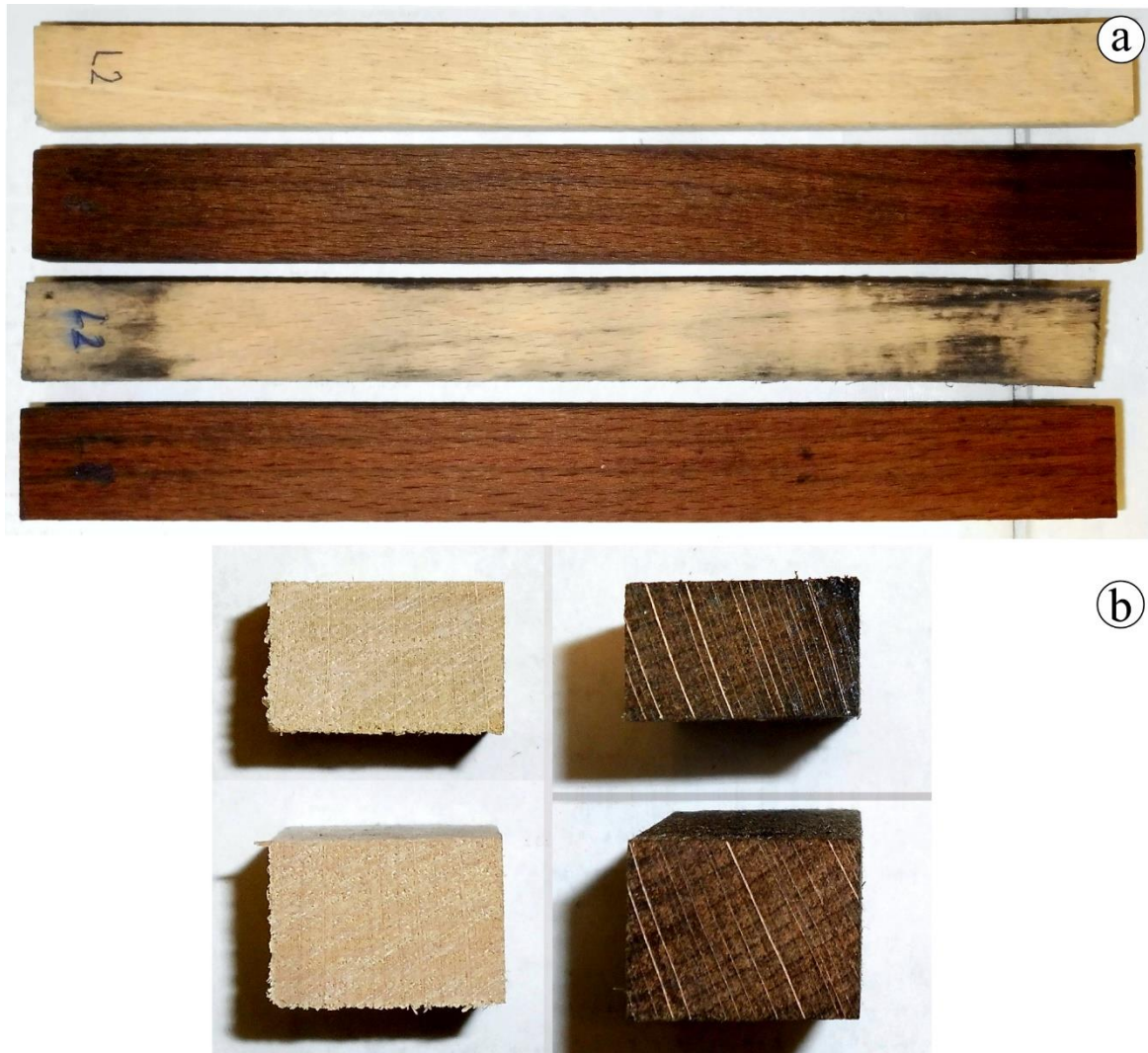
1. ábra. Kezeletlen (világos színű) és tejsav-oligomerrel telített (sötét színű) bükk minták oldalnézeti (a) és keresztmetszeti (b) képei. A hosszabb, de kisebb keresztmetszetű minták tömörítetlenek, míg a rövidebb, de nagyobb keresztmetszetűek tömörítettek
