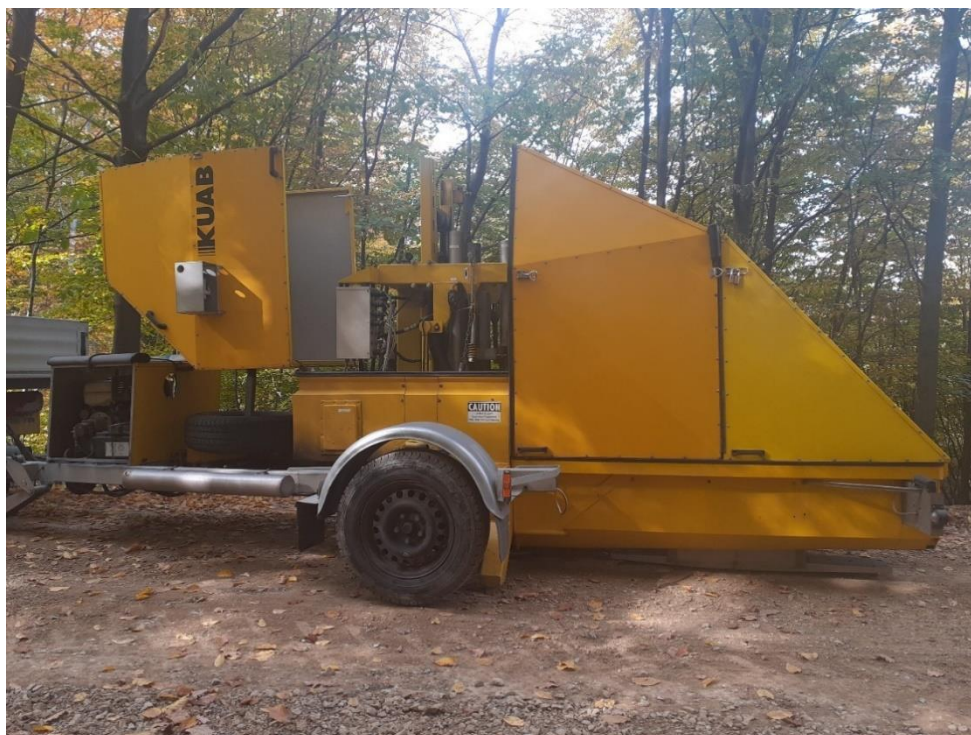
4. ábra. KUAB típusú FWD berendezés a stabilizált földművön történő mérés közben
