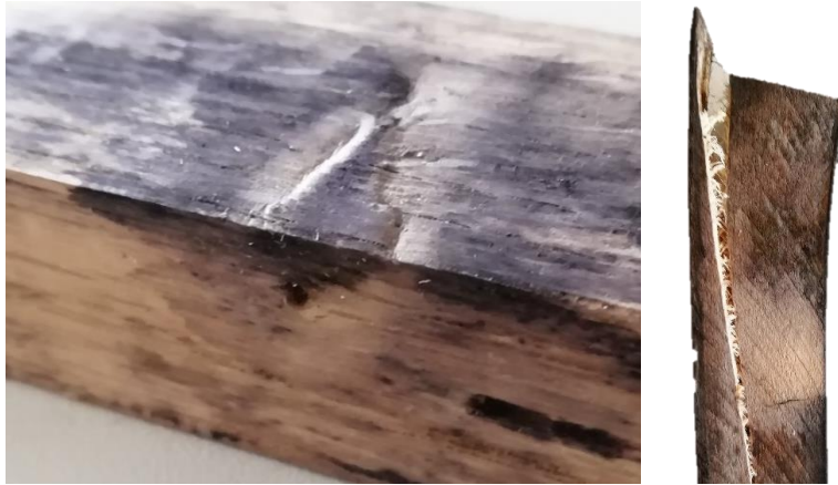
6. ábra: Tűgöcs a tömörített faanyagban (bal) ferdeszálúság miatti hasadás (jobb)
